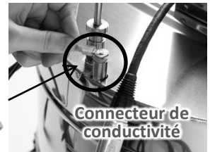
Sonde pour l'eau de la double paroi
